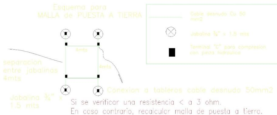
La conexión de las Jabalinas al cable se deberá hacer mediante soldadura exotérmica o con morsetos de compresión, mediante pinza hidráulica. No se permiten la instalación del morseto con tornillo.
